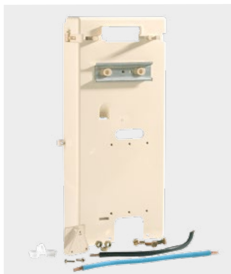
Platine compteur/disjoncteur pour branchement long (Type 2) Nom. Enedis 69.80.499 - Réf. 0945.075 La platine pour branchement long (Type 2) monophasé est destinée à recevoir le compteur électronique et le disjoncteur. Un cloisonnement interne permet des accès séparés aux zones NF C 14-100 et NF C 15-100.
